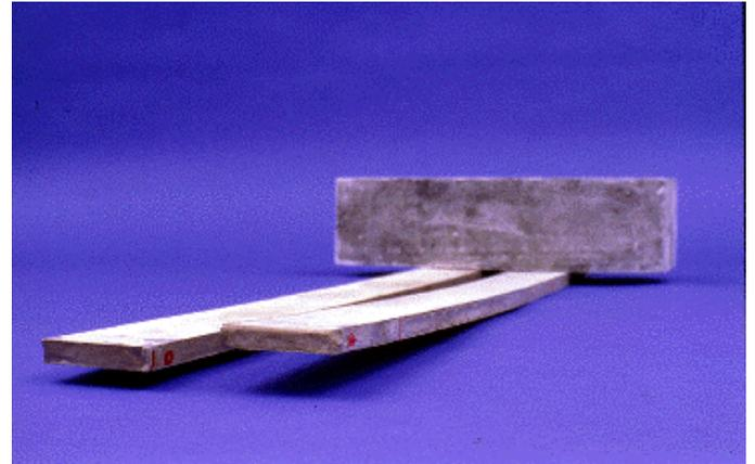
Les dalles de béton « gauchissent » à cause des différences d'humidité à travers l'épaisseur de la dalle, et donc des niveaux de retraits différents qui vont en découler .
